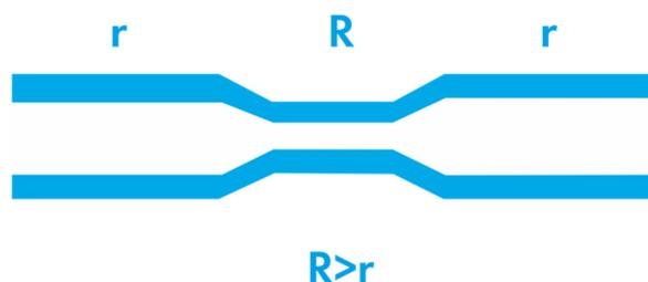
При использовании подобных некачественных проводов в месте растяжки на участке R повышается сопротивление и, как следствие, возникает повышенное тепловыделение и падение напряжения, что может привести к снижению напряжения питания терминала ниже допустимого или короткому замыканию в случае расплавления защитной оболочки провода.
