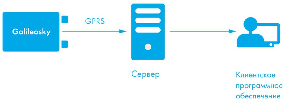
Для обеспечения сохранности данных при пропадании сети GSM/3G терминал Galileosky имеет внутреннюю энергонезависимую флэш-память. Встроенная аккумуляторная батарея позволяет поддерживать автономную работу терминала до 8 часов.
